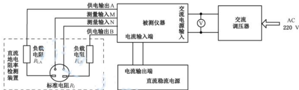
图7 电源适应性检测设备连接图
