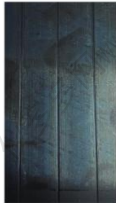
图 B.6 盐雾试验后的试样典型示例——未清洗的磨砂黑色阳极氧化膜表面的变色
