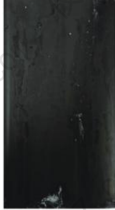
图 B.5 盐雾试验后的试样典型示例——未清洗的磨砂黑色阳极氧化膜表面的失光
