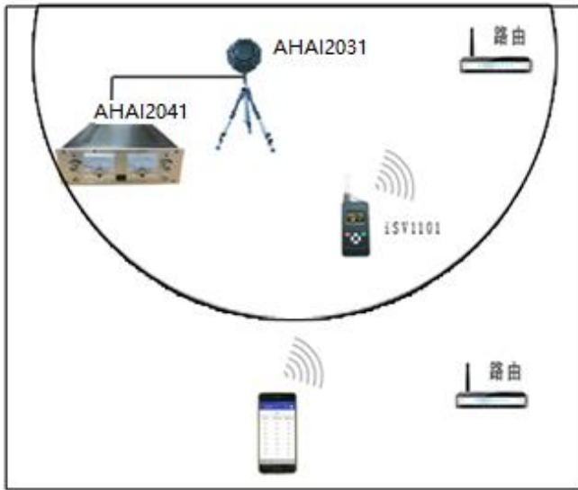
图 3-3 室内混响时间测量框图
