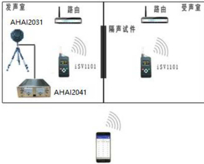
图 3-2 空气声隔声测量框图
