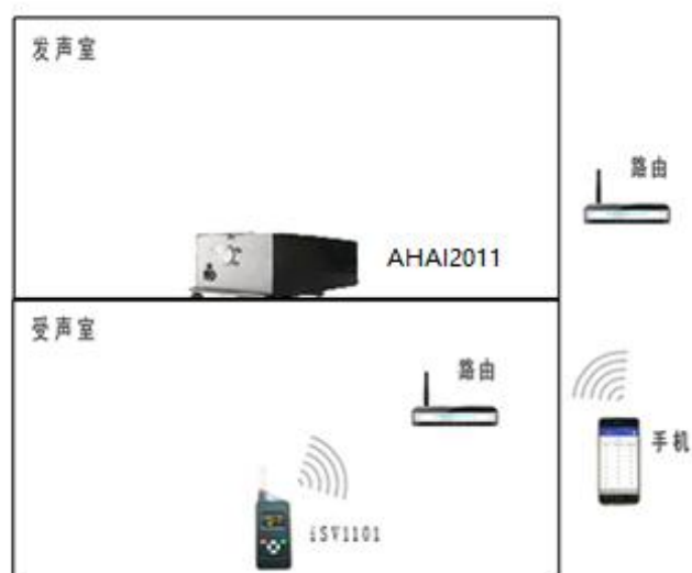
图 3-1 楼板撞击测量框图
