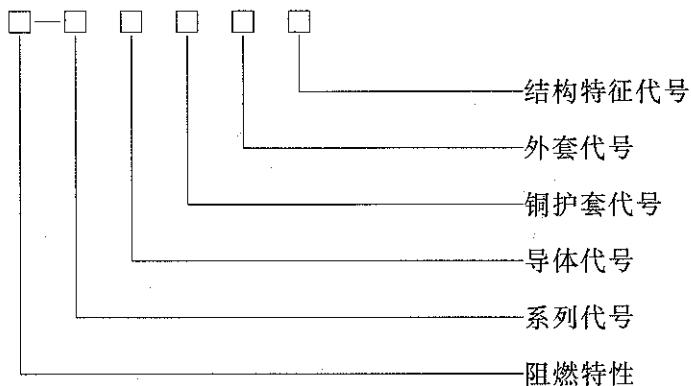
**B. 2.2 产品表示示例**示例 1：轻型铜芯铜护套矿物绝缘电缆，额定电压 500 V，单芯， $1.5 \text{ mm}^2$ ，表示为：
