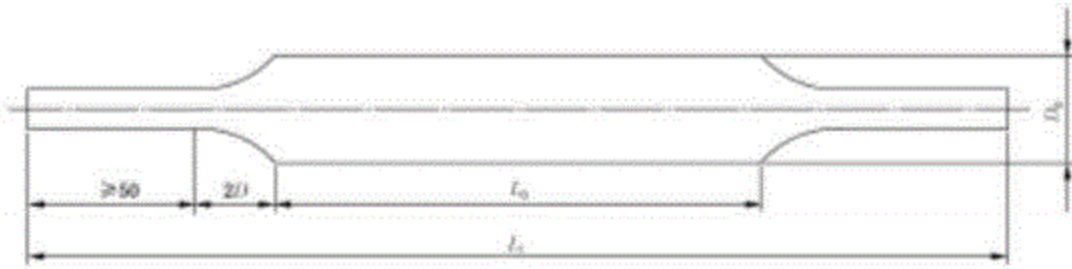
c) 压扁待测管段管材拉伸试样
