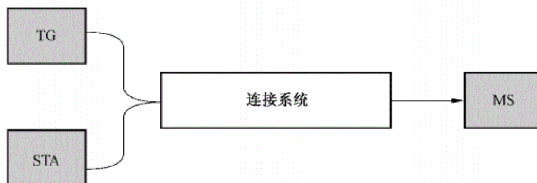
图 1 热分析-质谱联用装置组成示意图
