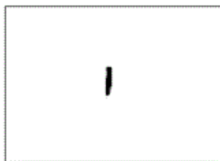
a) 质量等级 LP4b 或 AP4b 中不需评定的显示的最大尺寸
