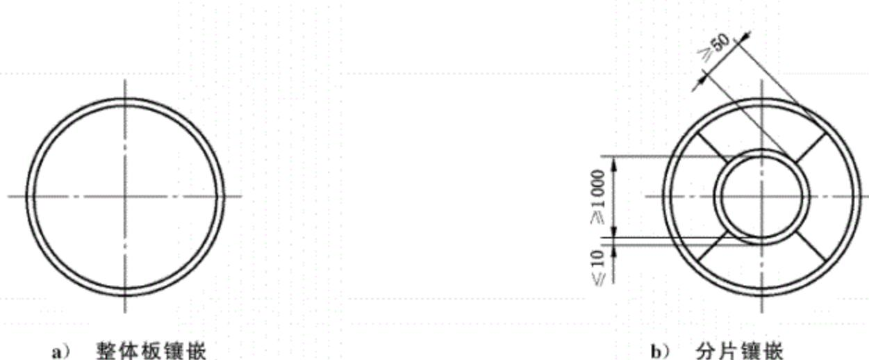
图2 摩擦材料镶嵌布置
