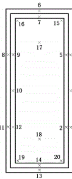
图 D.4 典型试件温度测点布置示意 4
