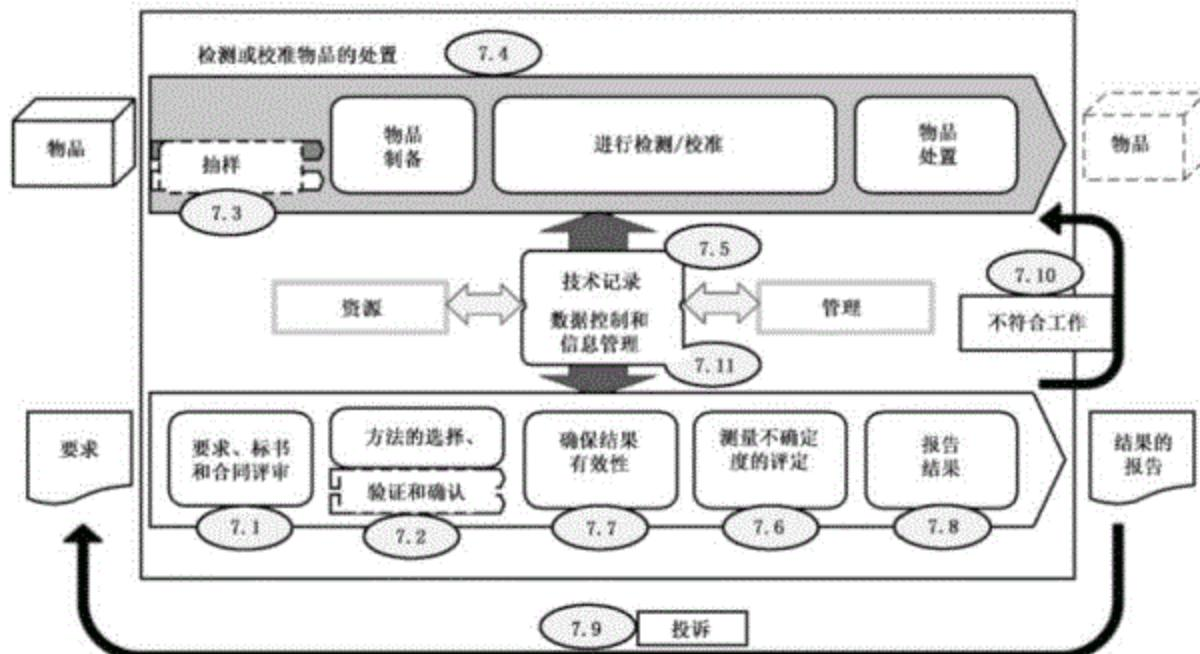
图 B.1 实验室运作过程的示意图
