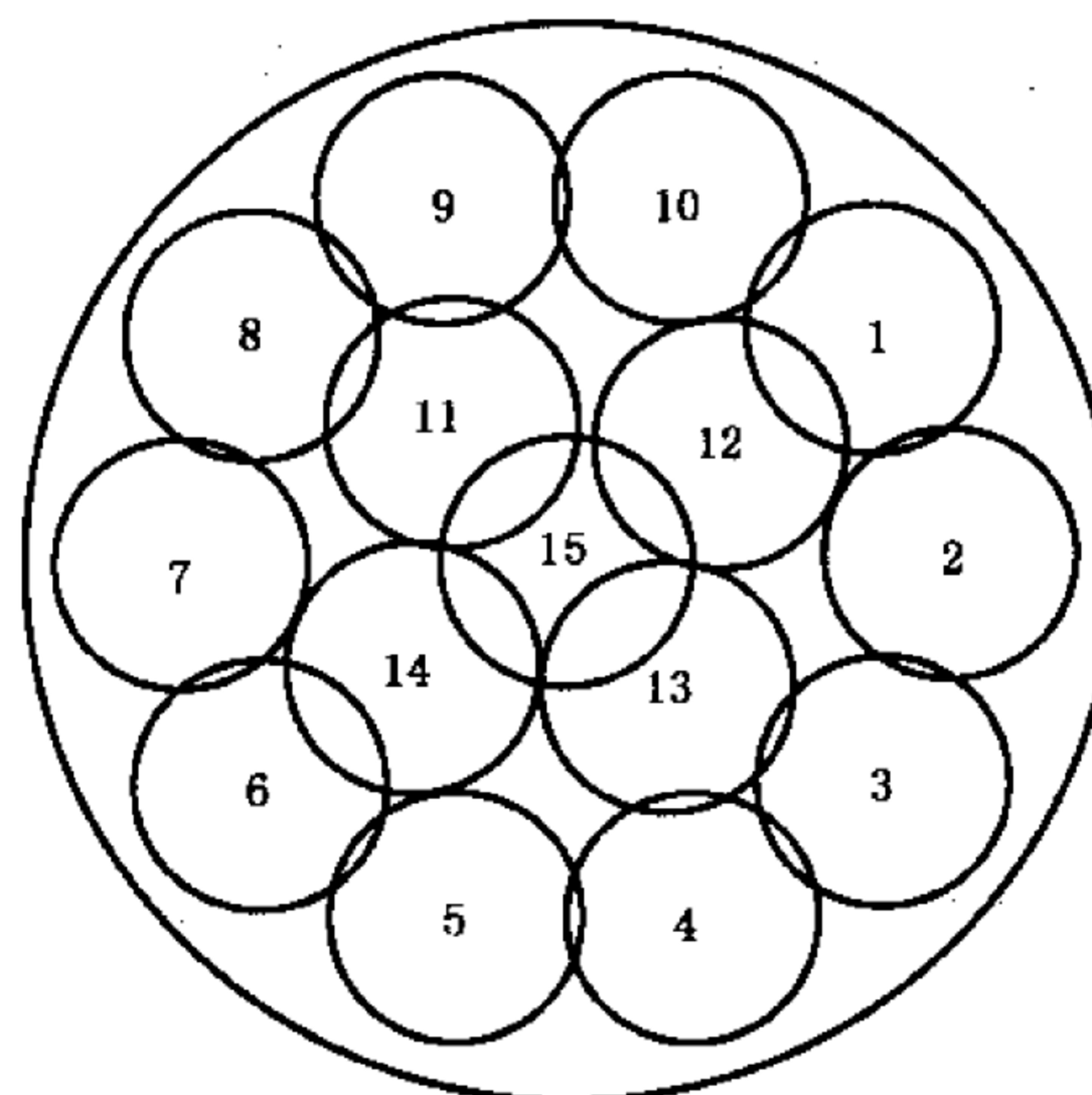
图 1 第一层捣压位置示意图
