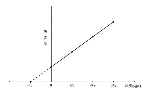
图B. 1 待测试样浓度与标准加入法标准曲线的关系
